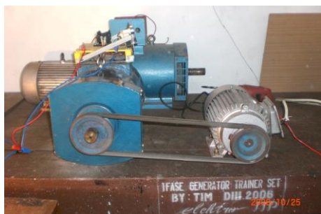
a. Motor terhubung dengan generator
