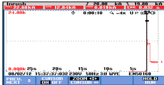
Gambar 9. Arus start motor saat menggunakan kapasitor 60 uF
